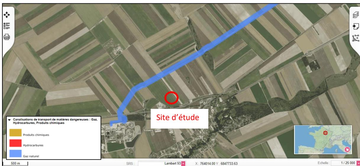
Figure 17 : Extrait de plan localisant les servitudes liées aux canalisations de transport de gaz et/ou hydrocarbures à proximité du projet (source : Géorisques)
